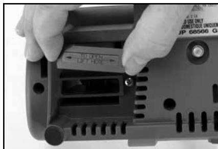
Figura 17. Retirada de la cubierta debajo de la base para limpiar el polvo metálico (consulte la sección Mantenimiento normal).
