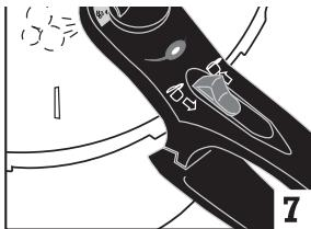
Ouvrir l'autocuiseur lorsqu'il n'y a plus de pression et que la soupape automatique ne laisse plus échapper de vapeur lorsqu'on déplace le poussoir de sécurité vers l'avant. NE JAMAIS PLONGER L'AUTOCUISEUR DANS L'EAU.
