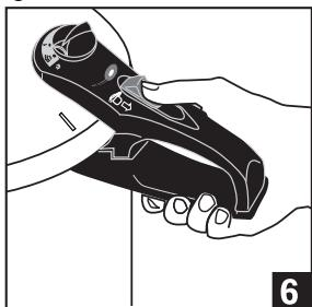
Para abrir la tapa, deslizar el pulsador HACIA ABAJO Y HACIA EL EXTREMO DEL MANGO. Por razones de seguridad, la olla no generará presión si el pulsador no está en la posición de cierre. Esta medida garantiza que la olla no se podrá abrir por descuido mientras haya presión en su interior.
